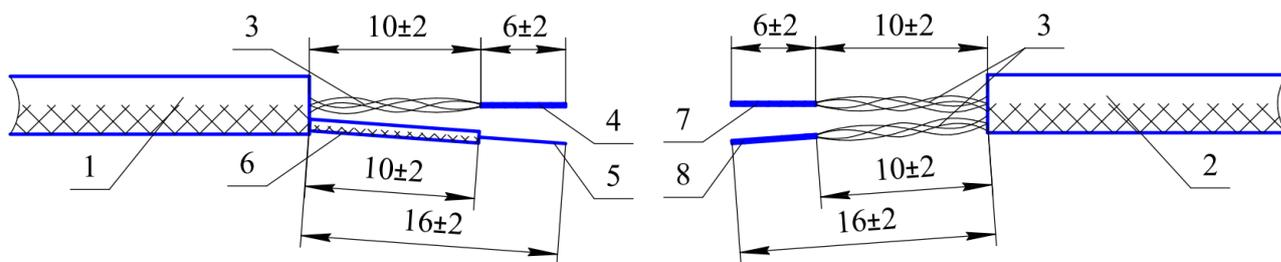
1 – кабель ЧЭ; 2 – кабель НЧЭ; 3 – центральные проводники кабелей; 4 – скрученные жилы центральных проводников кабеля; 5 – дренажная жила экрана; 6 – трубка изоляционная; 7 – свитые жилы четырех центральных проводников без полоски (соединяются со скрученными жилами центральных проводников ЧЭ); 8 – свитые жилы четырех центральных проводников с полосками (соединяются с дренажной жилой экрана ЧЭ).
