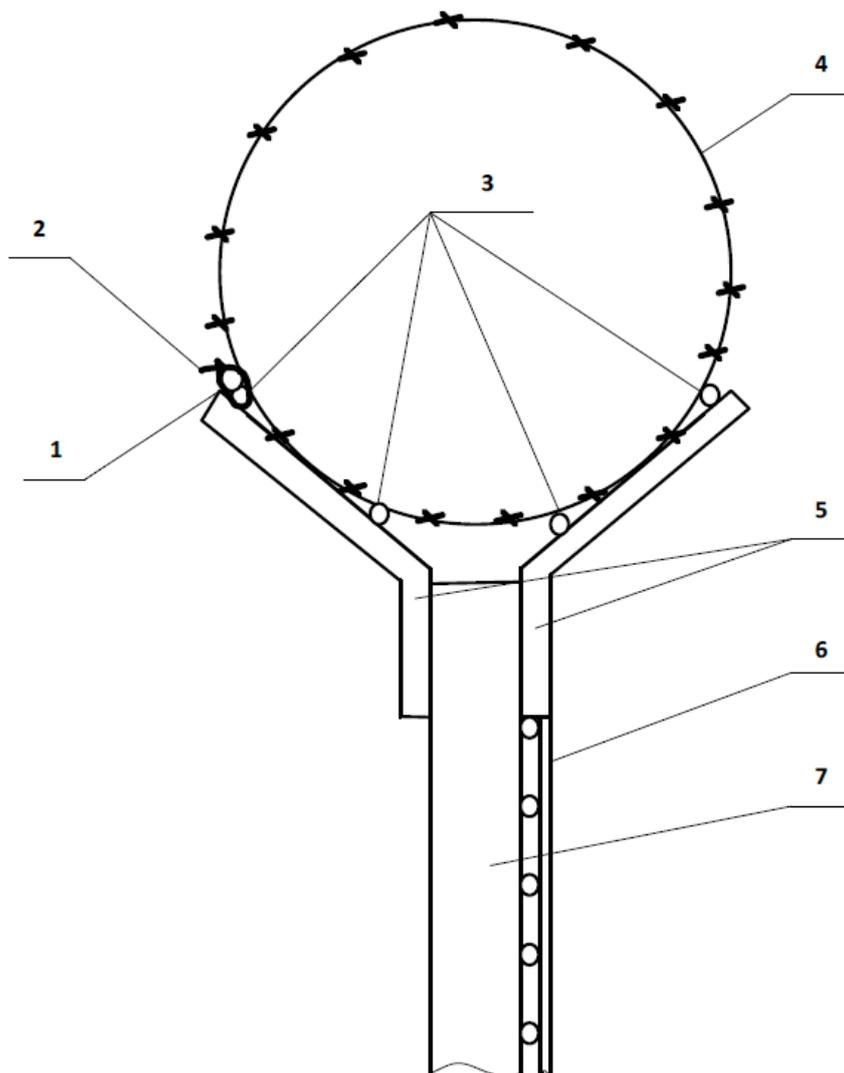
1 – ЧЭ (верхний); 2 – стяжка кабельная крепления ЧЭ к стальной проволоке (стальному тросу); 3 – стальная проволока (стальной трос); 4 – АКЛ; 5 – кронштейн; 6 – полотно СЗ; 7 – опора СЗ
