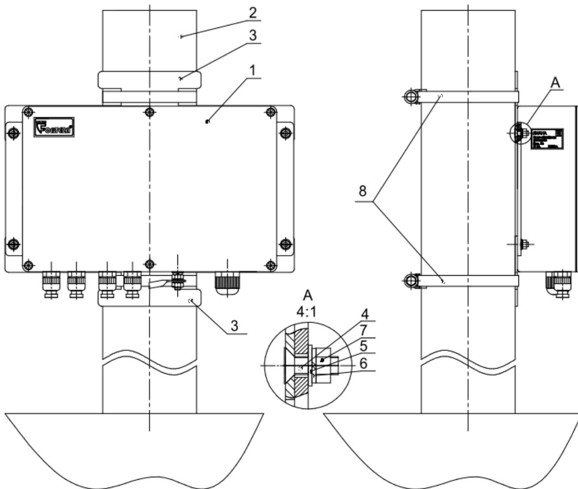
1 – БОС; 2 – опора; 3 – кронштейн ФРСБ.741354.001 – 2 шт. (из состава КМЧ); 4 – Винт DIN 965 M4x12-A2-70 – 4 шт. (из состава КМЧ); 5 – Шайба DIN 125-4,3-A2-70 – 4 шт. (из состава КМЧ); 6 – Шайба DIN 127-A4-A2-70 – 4 шт. (из состава КМЧ); 7 – Гайка DIN 934-M4-A2-70 – 4 шт. (из состава КМЧ); 7 – Хомут 70-90 – 2 шт. (из состава КМЧ)
