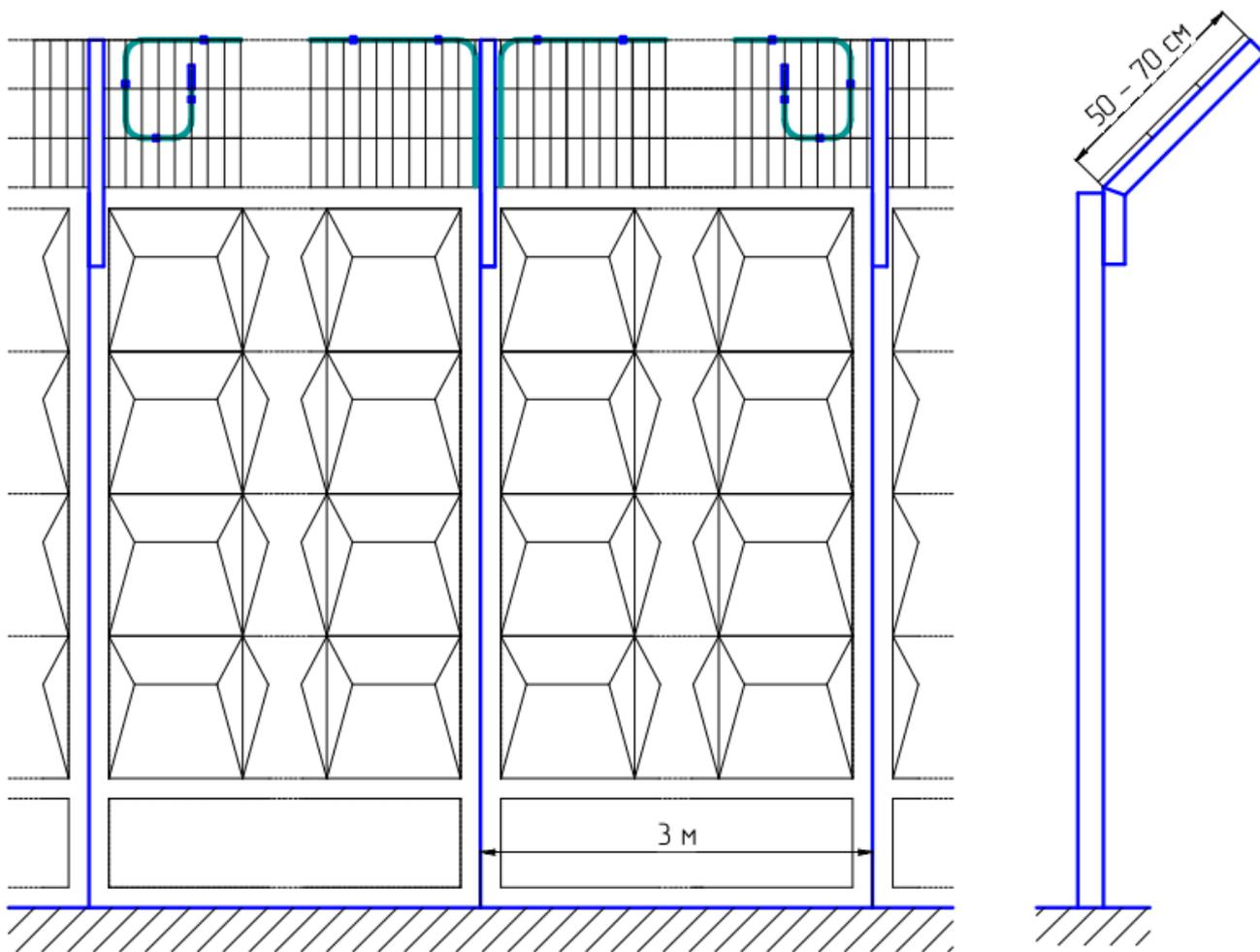
Рисунок 2.6 – Монтаж чувствительного элемента на козырьке сплошного заграждения
